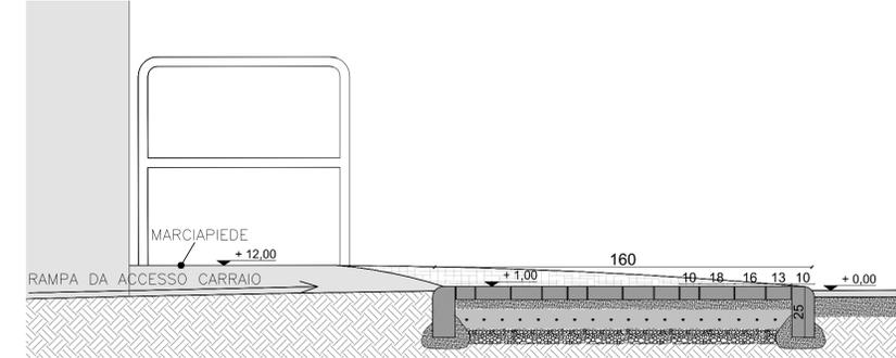
**Sezione C - C - Marciapiede longitudinale con bocca di lupo - scala 1:20**
